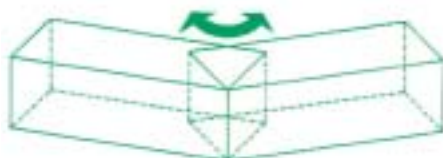
22. Konstruktion af udvendig radius etableres ved at skubbe kurvene ind i hinanden. Sæt sticklås i ved det udspringende hjørne. Skub derefter kurvene ind i hinanden. Alt efter radius er det nødvendigt at klippe de lodrette gittertråde over.
